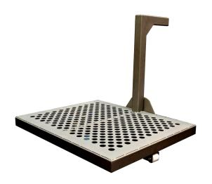
El equipo consta de una **bandeja móvil** donde se coloca el producto previamente empacado en el material termoencogible; luego se sumerge en el deposito de agua caliente del tanque durante un tiempo preestablecido, para que el empaque se adhiera al producto; Al terminar la bandeja retorna a su posición inicial.
